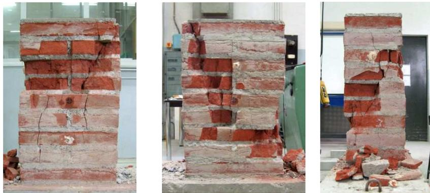
Figure 3 : Essais sur maçonnerie brique-mortier (Photos après rupture).
